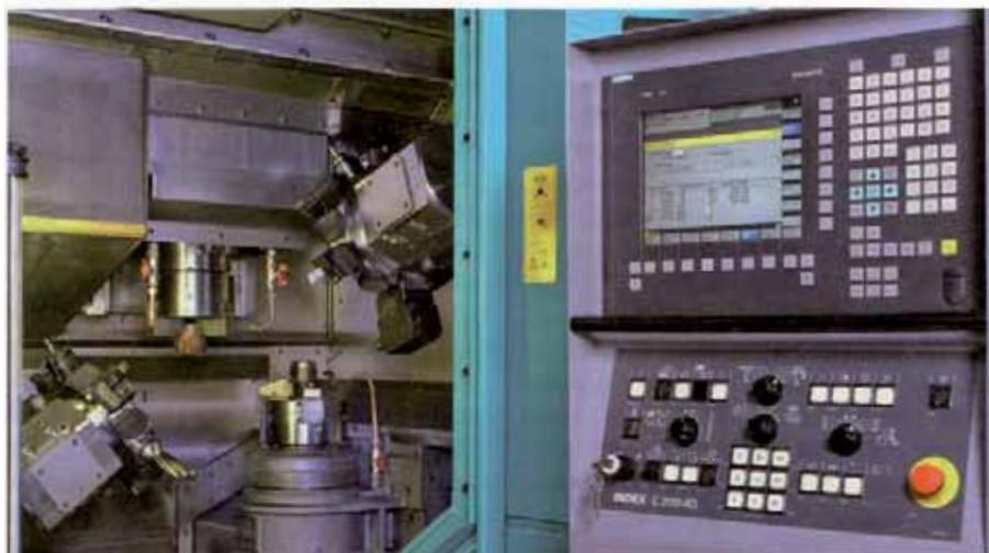
Impianto di tornitura e fresatura bimandrino verticale con alimentazione e scarico automatizzati, pubblicato anche su YouTube.
